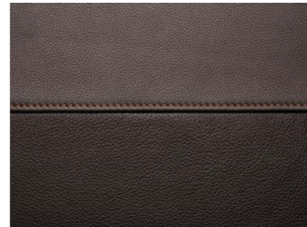
Einfache Kappnaht Simple french seam
